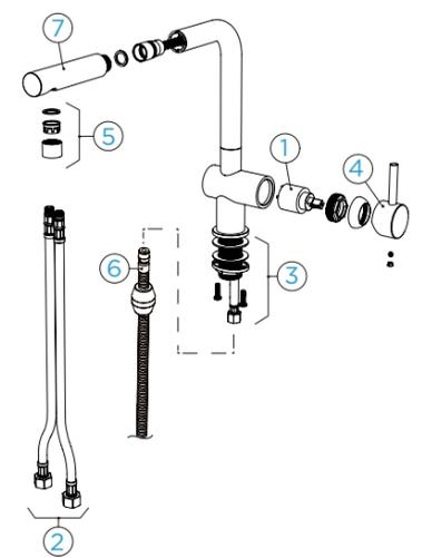
**Hinweis:** Diese Explosionszeichnung bildet die Hochdruck-Armatur mit deren Ersatzteilen ab. Für die Niederdruck-Armatur gelten andere Ersatzteilnummern.
